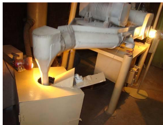
Установка по переработке люминесцентных ламп «Экотром-2» арендного предприятия ООО «Мерком», расположенного на территории института
