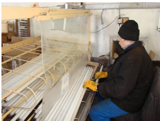
Установка по переработке люминесцентных ламп «Экотром-2» арендного предприятия ООО «Мерком», расположенного на территории института
