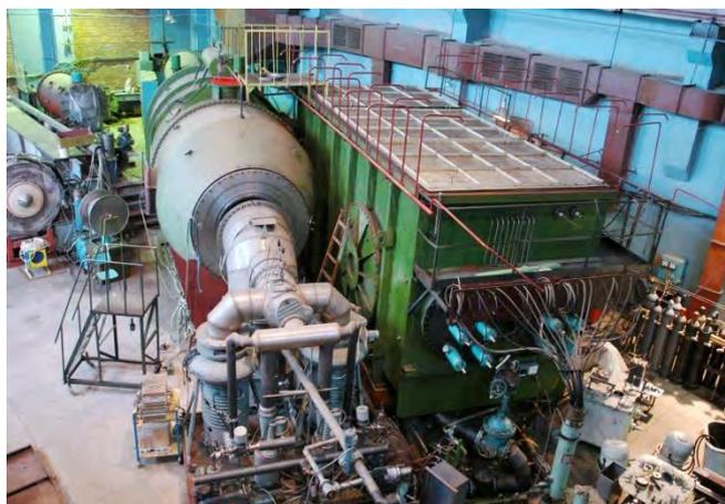
Импульсный ускоритель электронов
