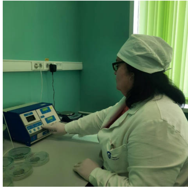
Радиохимический контроль подземных вод на радиометрической установке УМФ-2000
