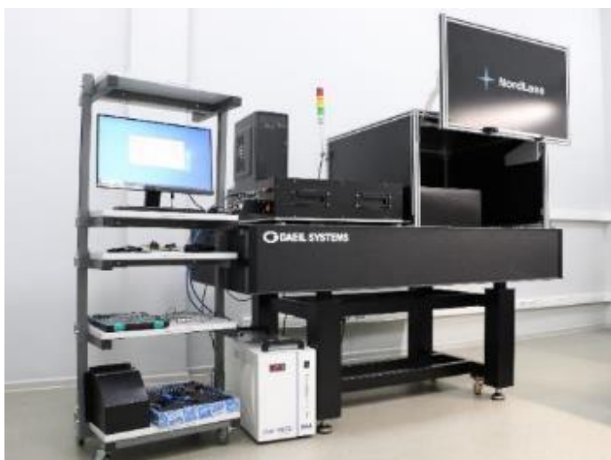
Рисунок 1 – Фотография общего вида установки с перестраиваемой длительностью импульса лазерного излучения, предназначенной для испытаний ЭКБ на стойкость к импульсным ионизирующим излучениям по критерию
