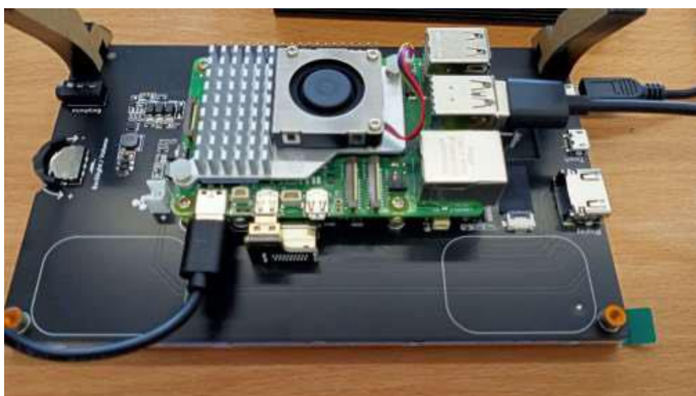
Рис. VI.3. Макет для отладки технологического ПО из состава стенда для измерения и визуализации распределения энергии электромагнитных колебаний (сигналов) в полосе частот от 1 МГц до 7 ГГц
