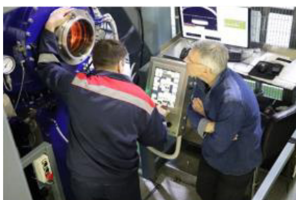
Рис. V.1. Фотографии, иллюстрирующие процесс выращивания слитков монокристаллического кремния методом бестигельной зонной плавки
