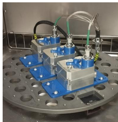
Рис. VI.2 – Фотография образцов ДУС на испытаниях
