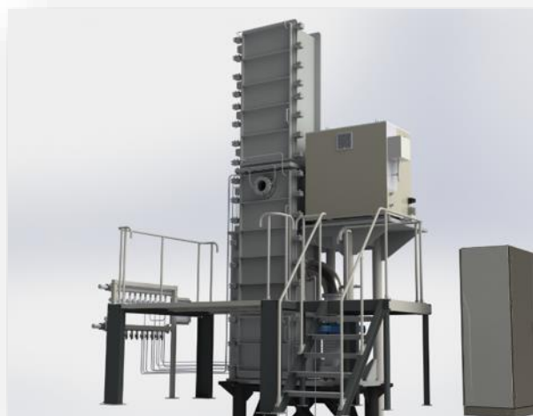
Рис. V.6. 3D модель установки для выращивания бездислокационных монокристаллов Si методом бестигельной зонной плавки кристаллического стержня с использованием индукционного источника плавки
