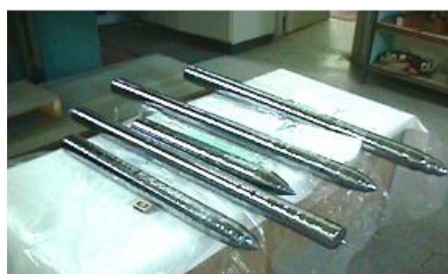
Рис. V.1. Фотографии, иллюстрирующие процесс выращивания слитков монокристаллического кремния методом бестигельной зонной плавки
